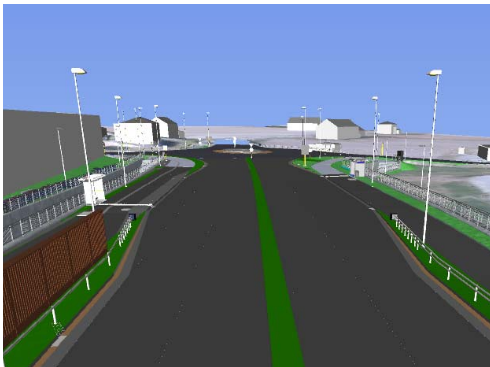
Fig. 4.5. Anbefalt plassering av master.
