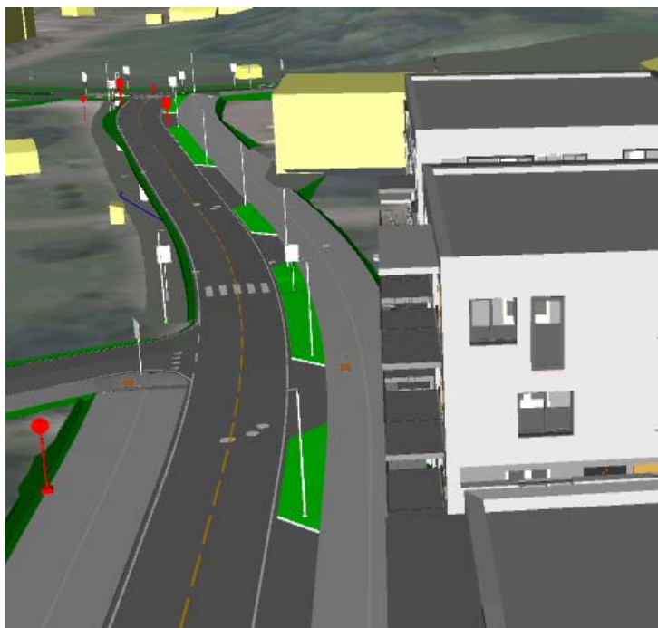
Fig. 3.2. Belysning skal følge samme side mellom kryss for å få enhetlig optisk føring.
