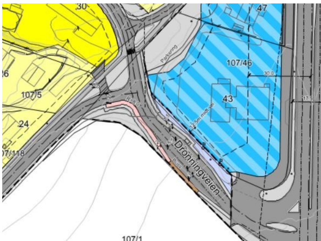
Kartutsnittet av reguleringsplanen. Dronningveien er regulert med veibredde 5,5 meter. Plattform ved busstopp og fortau er regulert, men ikke bygget ferdig.
