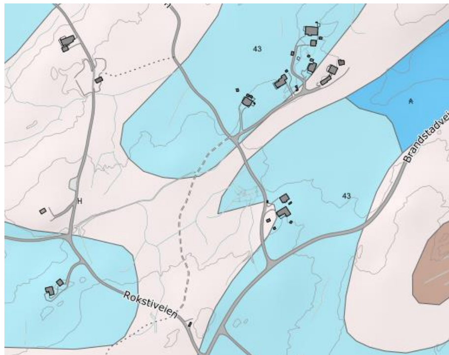
Figur 9 Løsmassekart, A3. Lys blått er tykk havavsetning. Mørk blått er marine strandavsetninger. Rosa farge indikerer bart fjell, lys brunt tynt humus-/torvdekke.
