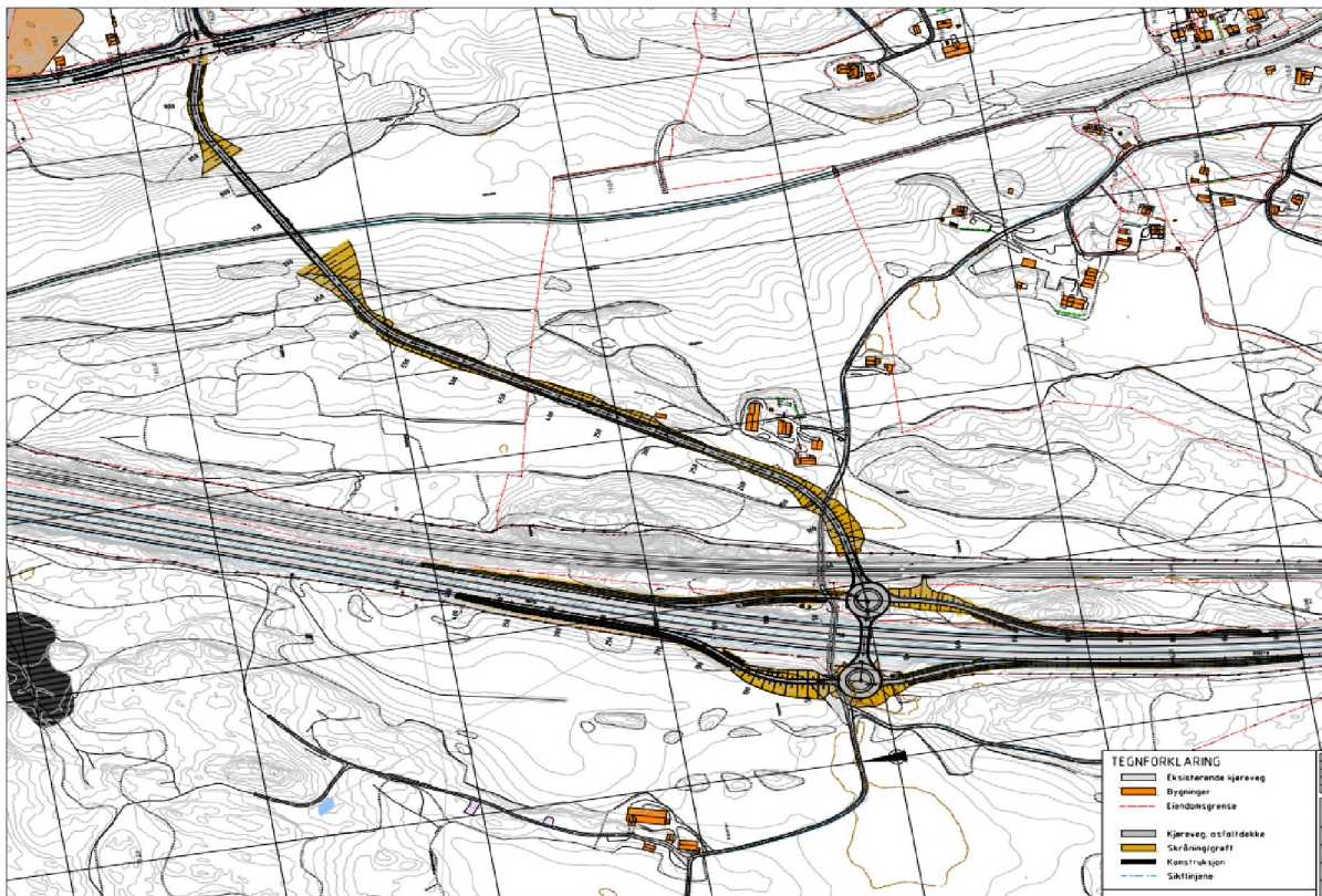
Figur 33-1: Oversikt over nytt kryss over E6.
