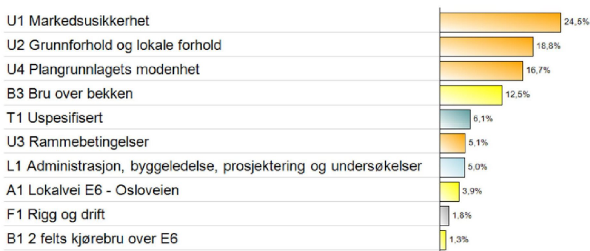
Figur 3-6: De 10 største bidragsyterne til prosjektets usikkerhet. Prosentatsen angir hvor stor del av prosjektets usikkerhet som ville blitt borte dersom angitt post ikke hadde hatt usikkerhet.
